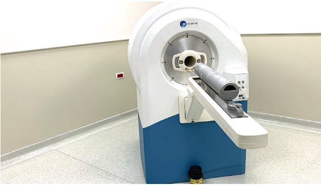
Şekil 3. MR Solutions- Klinik öncesi, cryogen-free 7T MRG ve entegre \mu PET insert sistemi (16) MRG: Manyetik rezonans görüntüleme, \mu PET: Mikro-pozitron emisyon tomografi
