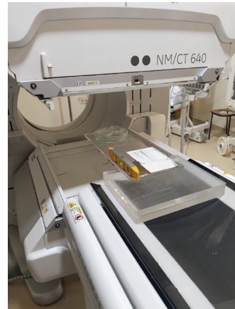
Resim 3. Sistem planar hassasiyet testi düzeneği
