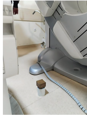
Resim 2. Havada içsel sayım hızı performansı test düzeneği
